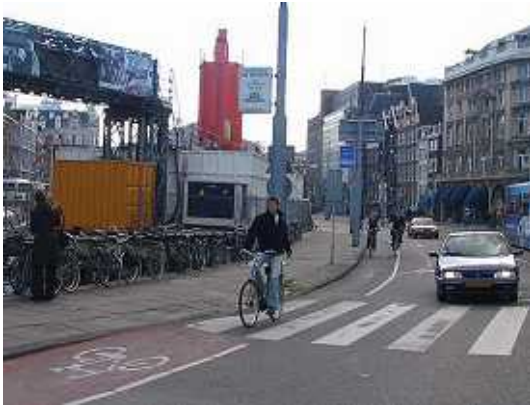
車道側に設置された自転車レーン （アムステルダム） 写真提供/湯本登
